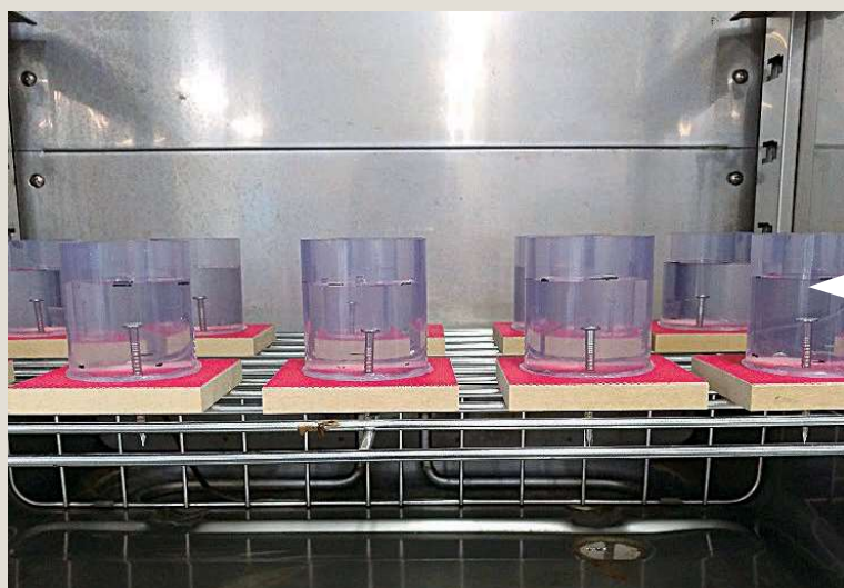
釘穴止水試験
